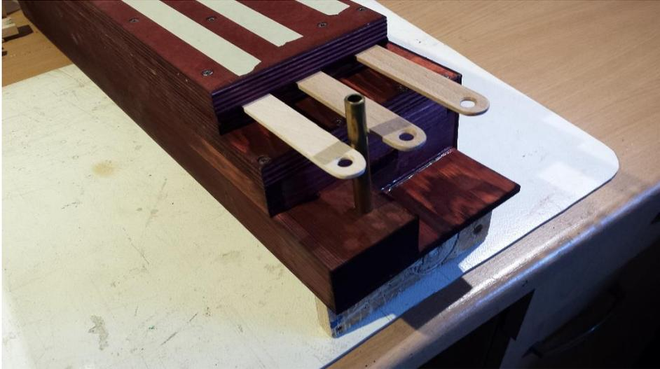
So habe ich die 10mm Bohrung der Windzufuhr der Pfeife von unten nach oben wieder aufgebohrt.
