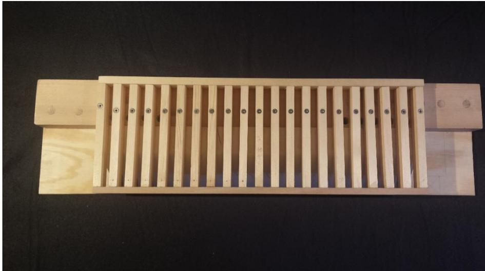
Die Kazzellenwände bestehen aus Fichtenleisten mit den Maßen: 137 x 20 x 10 mm
