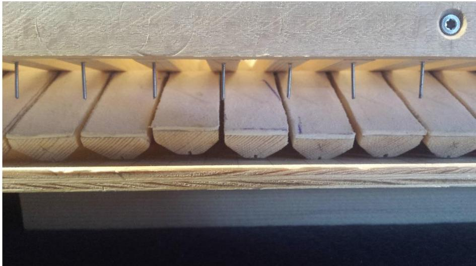
Die Leisten der Kazzellenwände erhielten von der Unterseite 1mm starke Führungsstifte für die Klötzchen - Ventile. (Diese stehen nicht schräge, es ist die Haltung der Kamera)
