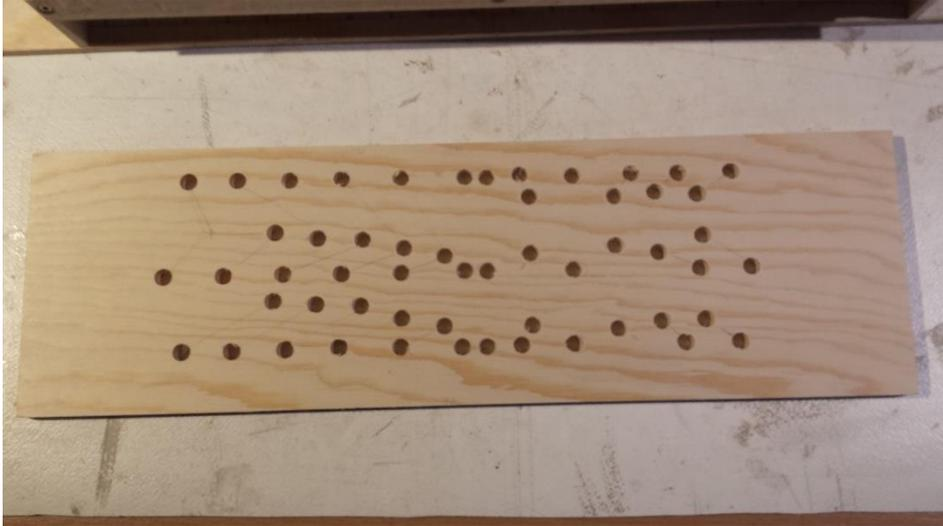
Dieses Foto zeigt sämtliche Bohrungen für die Kondukte 1.- 3. Registern. Bohrungen: 8mm
