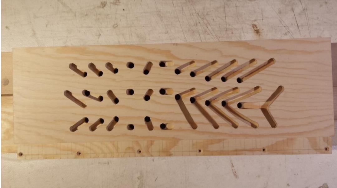
Kondukt-Platte auf die Abdeckplatte der Kanzellen aufgelegt. Der Querschnitt der Kondukte der Registerpfeifen beträgt 8 x 8 mm.
