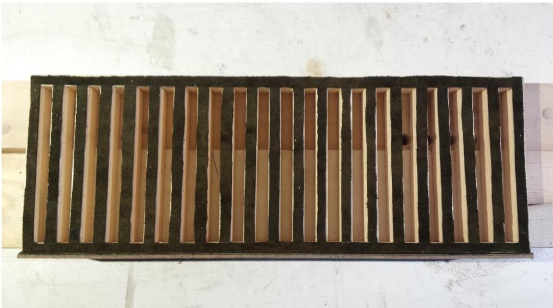
Vor dem Zusammenbau der einzelnen Ebenen erhalten die Kanzellenwände noch eine Lederdichtung, da diese Ebene nicht geleimt, sondern verschraubt werden soll.
