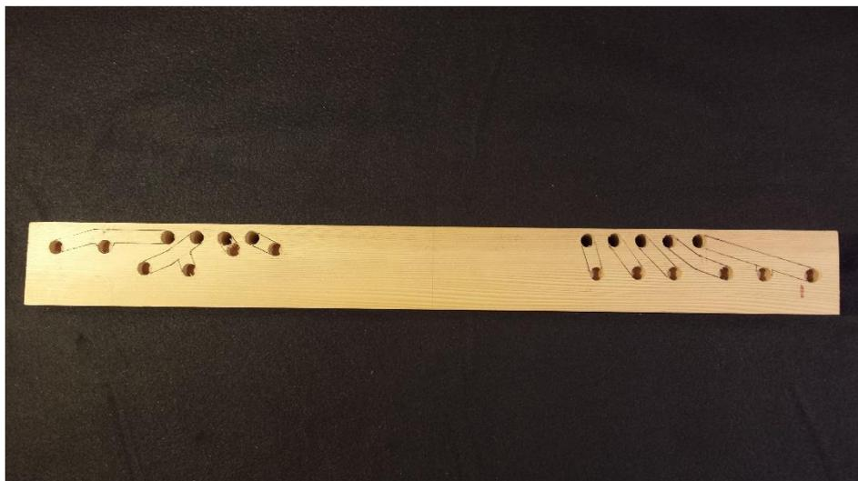
Danach wurden die 10mm Löcher für die Windzufuhr der Pfeifen mit dem Zentrierbohrer von beiden Seiten gebohrt. So entstehen keine Ausfransungen an den Rändern.
