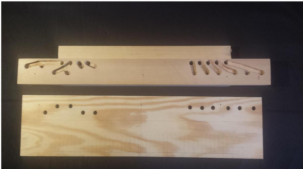
Im oberen Bereich des Fotos sind die gefrästen Kondukte sichtbar, darunter die Bodenplatte aus Kiefer mit den Maßen 597 x 147 x 6 mm.
