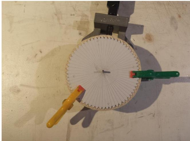
Zuschnitt der Zähne mit einem Anschlag.
