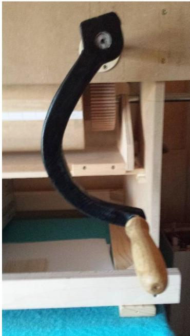
Um eine vorläufige Kurbellänge zu ermitteln habe ich eine verschiebbare Kurbel gebaut. Nach einigem Testen hat sich eine Achslänge von 200mm ergeben. Ob es für die Kraftübertragung mit dem Balg reicht, wird sich später ergeben.
