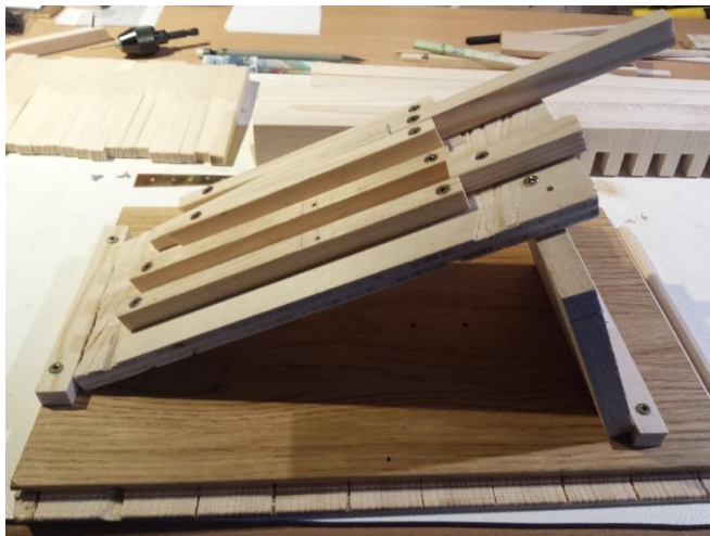
Bohrschablone für die Clavesstifte 25° Schrägstellung
