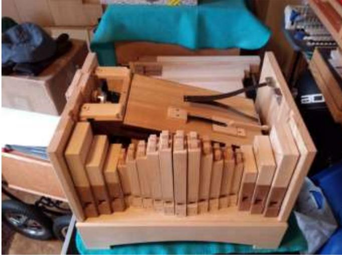
Als weiterführende Teile werden die Aufnahmewinkel der Balgfeder, der Anschlag für das Überdruckventil und der Anschlaghebel des Ventils gefertigt und eingebaut.
