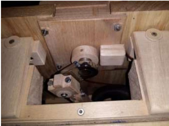
Für das Drehzahlgesteuerte Spielen müssen zwei Magnete in nicht magnetisches Material eingefasst werden. Ich habe dafür auf der Drehbank einen Ring aus Holz drehen lassen. Mit einem Abstand von 1,0mm habe ich den Impulsgeber befestigt.
