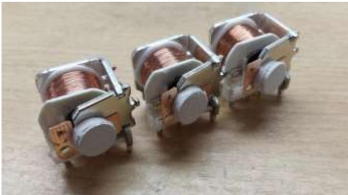
Bei den Relais wird vorsichtig die seitliche Feder und die Wippe abgebaut und der untere vorstehende Kunststoff- Sockel wird abgeschliffen. Dabei ist unbedingt darauf zu achten, dass die sehr dünne Spulenwicklung nicht mit den Fingern berührt wird. Dies reißt an den Lötstiften sehr schnell ab. Auch schieben sich die Wicklungen übereinander.
