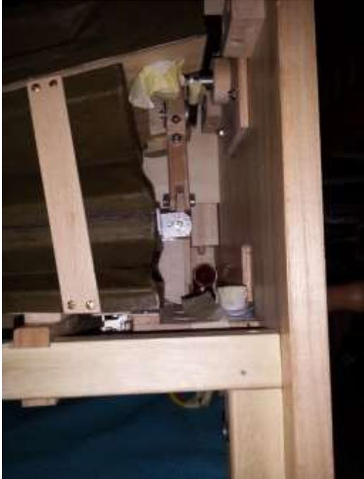
Die Stößelstange zwischen den Mitnehmern ist auch aus 15mm Buche gefertigt. Nachdem der obere und untere Mitnehmer befestigt ist, kann das Zwischenmaß ermittelt werden. Die ganze Einheit arbeitet als Gelenk und ist mit M4 Inbusschrauben mit Stopmmuttern verschraubt.
