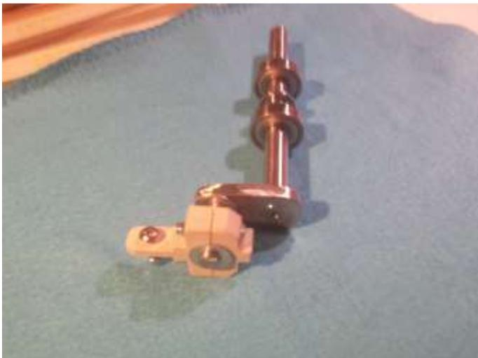
Um Gewicht zu sparen habe ich den Stößelmitnehmer aus 15mm Buchenholz gefertigt. Der Mitnehmer auf der Kurbel wird Mangels einer Fräse aus einem Stück VA-Flacheisen geschnitten, geschliffen und poliert. Allerdings habe ich mir das 15mm Bohrloch für die Kurbelachse in einer Fachwerkstatt für passenden Sitz für eine kleine Spende in die Kaffeekasse (Ja, so etwas gibt es auf dem Land noch) einfräsen lassen.
