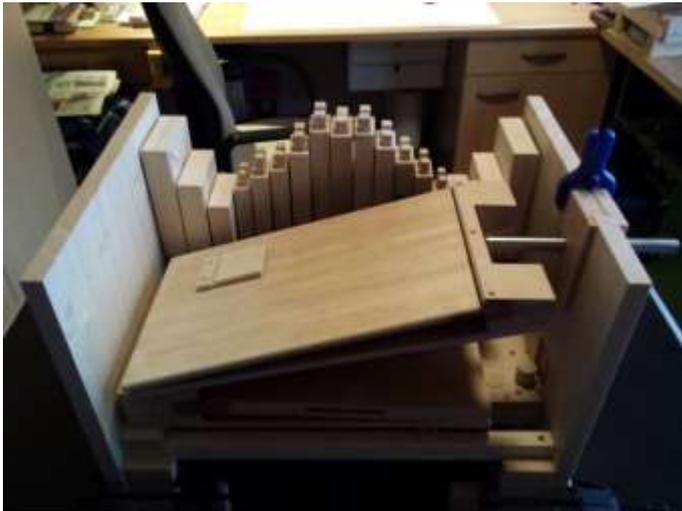
Der Ausschnitt der Kurbelhalterung ist ausgeschnitten und die zusammengefügte Halterung mit der Überlangen Kurbel wird für die Festlegung der Kurbellänge prov. eingebaut.
