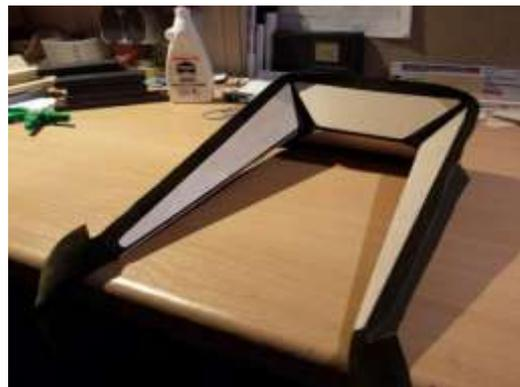
In der Mitte kann die Verstärkung gerne zusammenstoßen, da sie nach innen gefaltet wird. Außen steht das Leder 11mm über die Verstärkungen über. Dieses resultiert aus der 8mm breiten Verleimungsfläche und 3mm Luft zu den Sperrholzverstärkungen.
