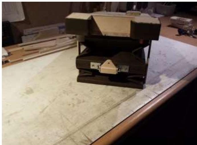
Die Belederung wird auch umlaufend über den Balg- Bock und den Windauslass des Magazins herumgeführt. Die Feder des Überdruckventils ist aus einem Stück Bandeisen einer Palettenverpackung welche im Lager des Baustoffhandels kostenlos erhältlich war zurechtgebogen und funktioniert gut.
