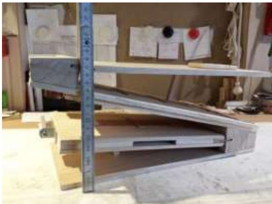
Der fertige Rohbau mit 180mm Bauhöhe.
