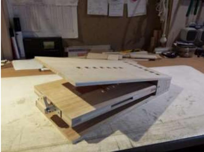
Der Schöpfbalg mit der Schöpferplatte. Das Scharnier besteht aus einem 3mm dicken weichen Lederstreifen. Der Stößel - Mitnehmer wird von zwei Aluwinkel getragen.
