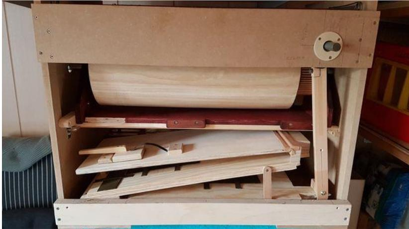
Als weitere Arbeiten wurden div. Metallteile brüniert und wieder eingebaut. Dazu gehörte auch die Fertigung der Kurbel – Wangen, und des Mitnehmers am Schöpfer. Der Balg wurde zu den Kurbelwangen ausgerichtet, so dass der Stößel nirgends anstößt.
