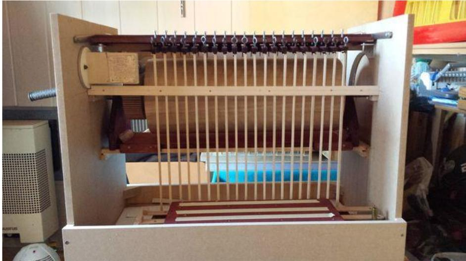
Die Quadratischen Leisten sind durch einen Führungsrechen geführt, damit ist eine Verdrehung gesichert.
