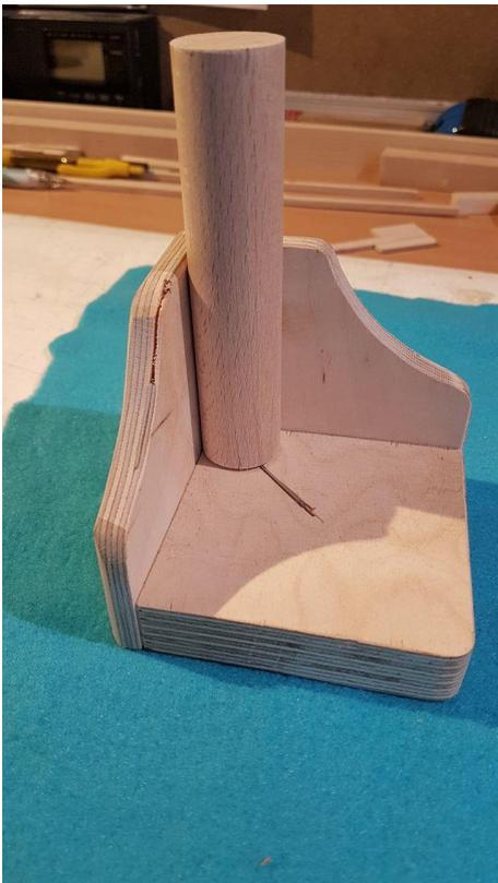
Über Kreuz wird ein kleiner Schlitz eingeschlagen und angekörnt.
