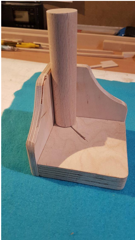
Linke Seite: Achse mit dem Mittenfinder über Kreuz markieren.
